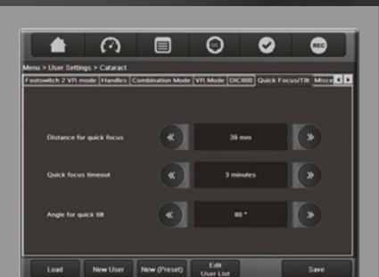
Selezionate la messa a fuoco rapida (Quick Focus) per commutare immediatamente tra due diversi piani confocali e l'inclinazione rapida (Quick Tilt) per rendere più efficiente il flusso di lavoro nelle procedure di intervento del glaucoma
